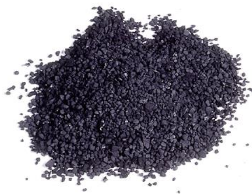
Figura 12 - Carvão ativado granulado (Materiais Gráficos AQ, 2010)
