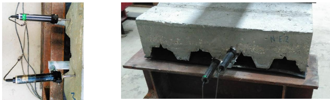
Figura 3.12 – Disposição dos LVDT's de 50 mm
