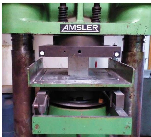
Figura 3.1 – Ensaio de uma amostra dos provetes cúbicos de betão
