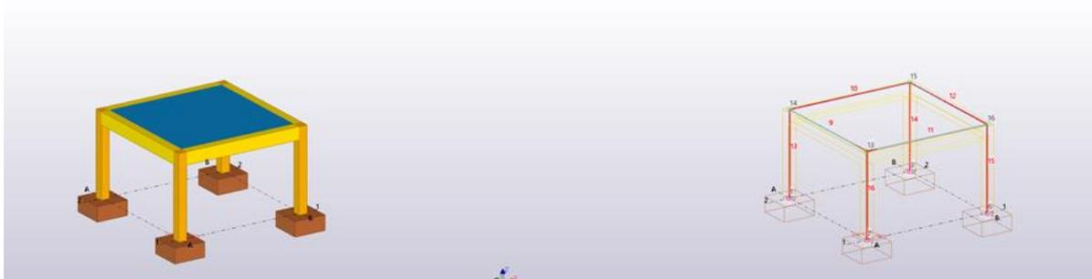
Figura 3.8: Modelo físico e modelo Analítico no Tekla
