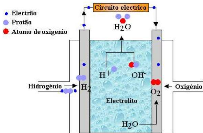
Figura 8 - Processo electroquímico de uma pilha de combustível (fonte: Introdução à Cogeração – Rui M. G. Castro, 2008)
