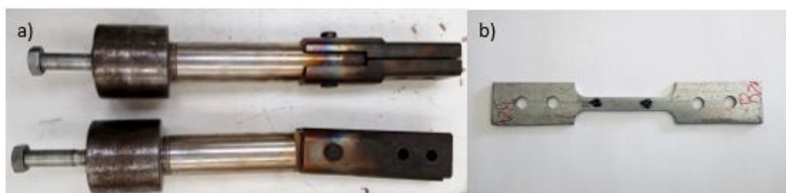
Figura 3-6 a) Garras de aço refratário usadas no desenvolvimento dos ensaios de tração. b) Exemplo de um provete usado nos ensaios.
