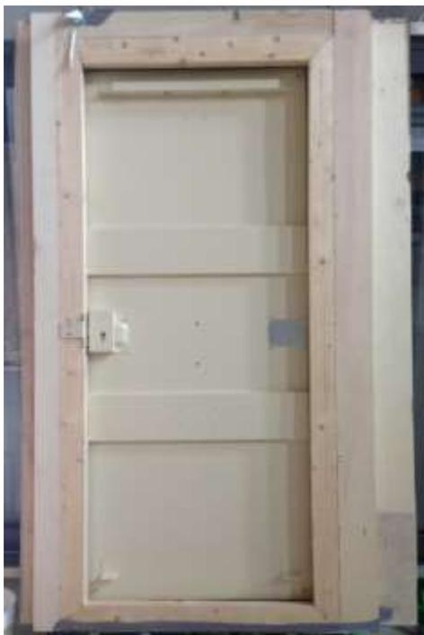
Figura 4.4 - Porta sem grelha de ventilação ensaiada
