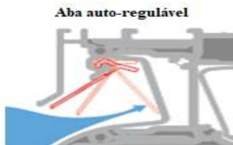
Figura 2.10 – Sistema de ventilação auto-regulável (Renson, SEM DATA)
