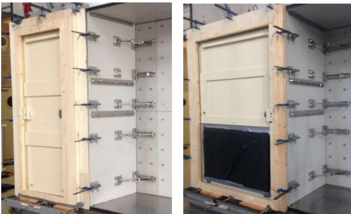
Figura 4.6 – Ensaio com as duas portas instaladas na câmara
