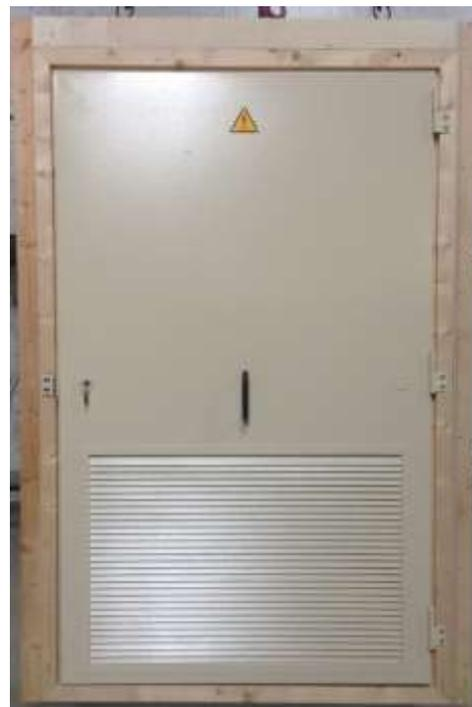
Figura 4.5 – Porta com grelha de ventilação ensaiada
