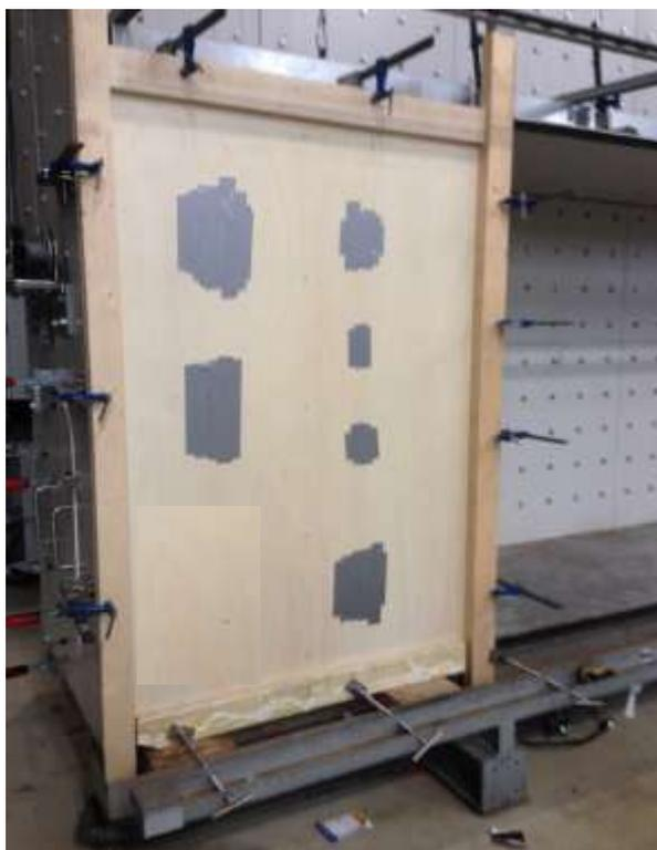
Figura 4.2 – Ensaio com as aberturas todas seladas
