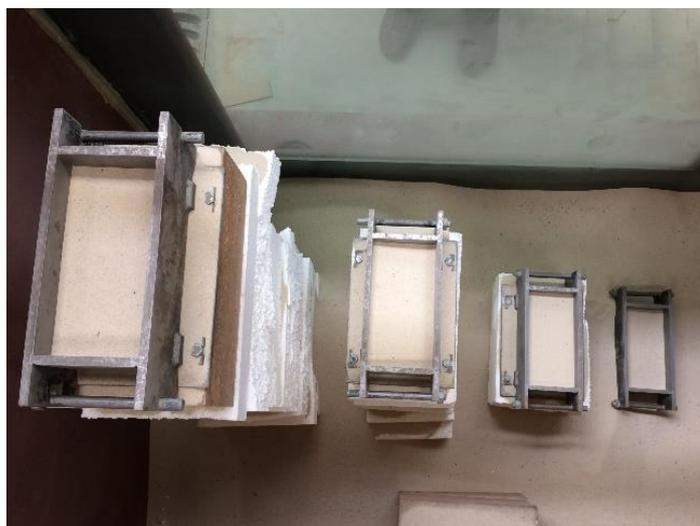
Figura 5.12 – Pormenor dos provetes onde se verifica um maior preenchimento nos dois moldes centrais.
