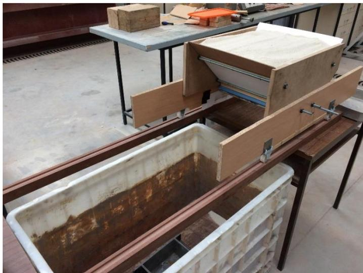
Figura 4.6 – Sistema de pluviação com os respetivos carris.
