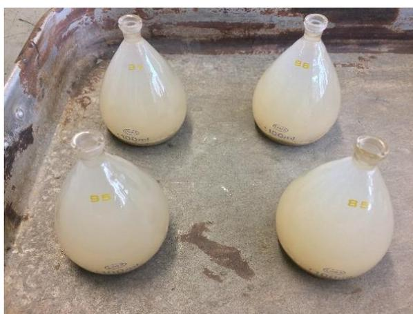
Figura 3.2 – Picnómetros usados nos ensaios.
