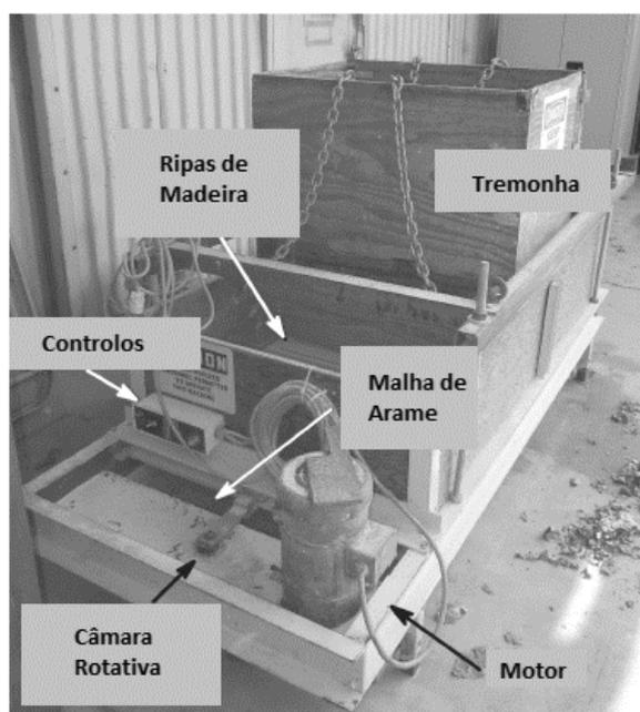
Figura 2.11 – Pluviador para amostras com densidades médias a densas (adaptado de Stringer *et al.*, 2014).
