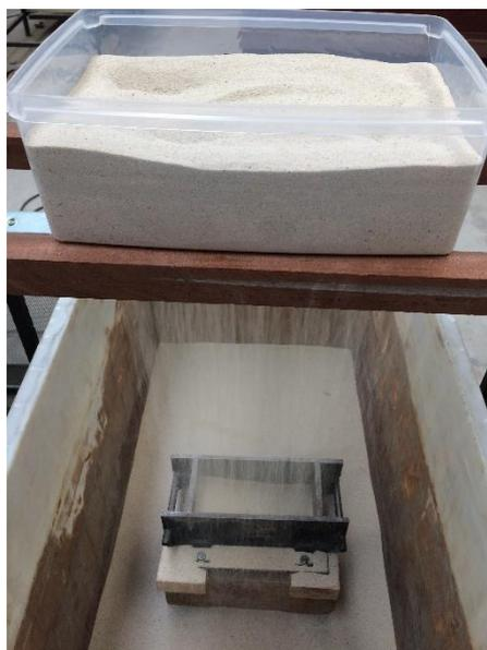
Figura 5.6 – Realização de um ensaio de pluviação sem peneiro e com o molde retangular.
