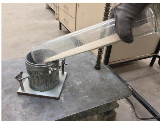
Figura 3.5 – Colocação de uma camada de areia dentro do provete.
