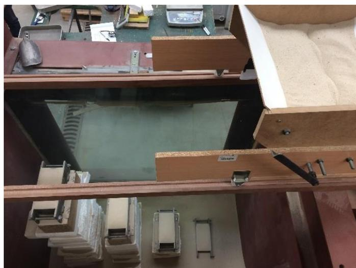
Figura 5.13 – Colocação do pluviador e dos carris sobre o tanque em relação aos provetes.
