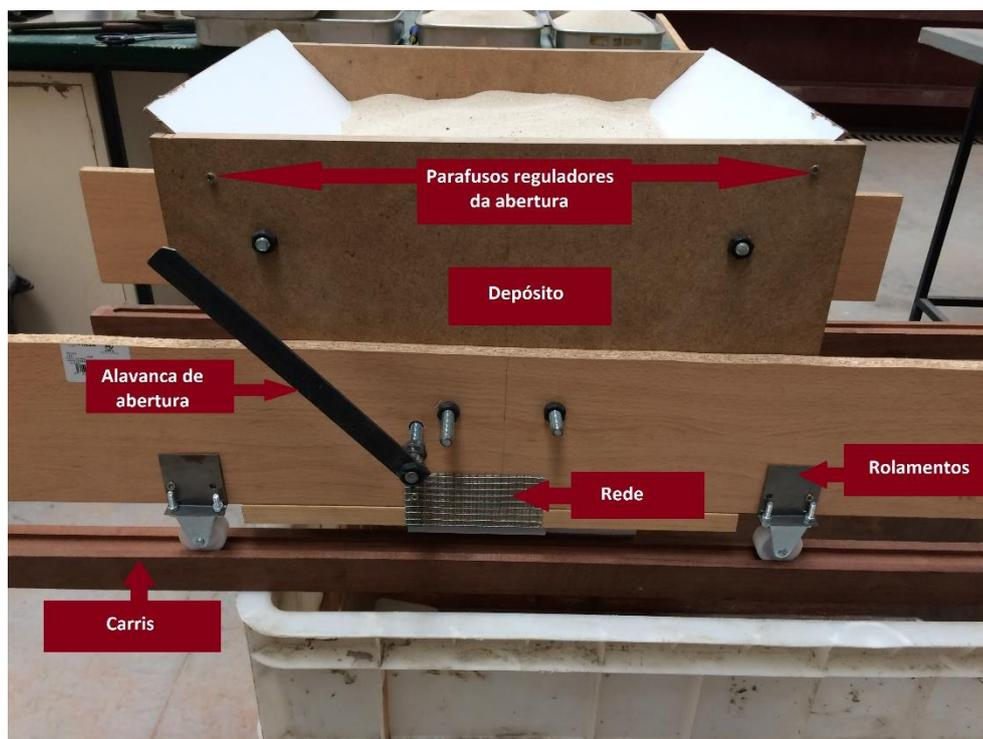
Figura 4.4 – Modelo reduzido do pluviador.
