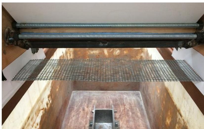
Figura 4.5 – Pormenor da parte inferior do pluviador.
