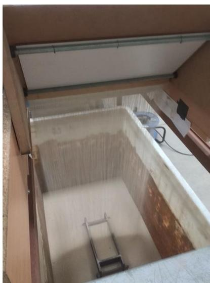
Figura 5.9 – Pluviação de areia durante um ensaio sem utilização de malha.
