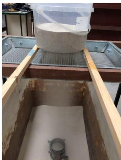
Figura 5.2 – Realização do processo de pluviação com utilização de um peneiro.
