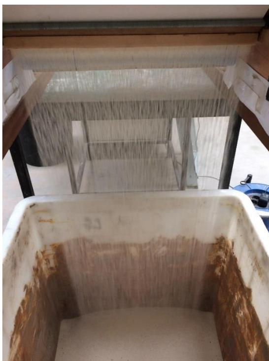
Figura 4.7 – Cortina formada pela areia durante a pluviação.
