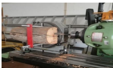
Figura 3.6- Furação dos provetes através de um torno mecânico.
