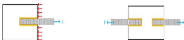
Figura 2.7- Ensaio de tração-compressão (esq. a ), e tração-tração (dir. a ) (Rajčić et al 2016).
