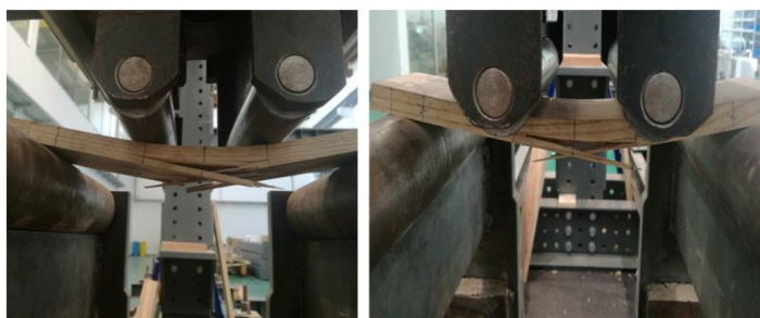
Figura 4.12- Ilustração das roturas observadas nos ensaios de flexão.
