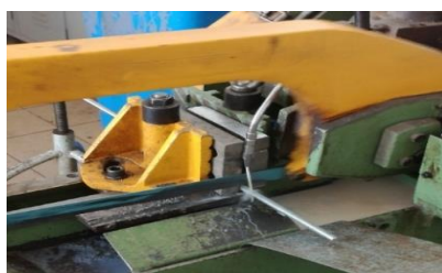
Figura 3.8- Corte transversal dos varões de aço roscado em serra de fita.
