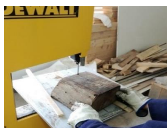
Figura 3.5- Corte longitudinal das vigas de madeira antiga.
