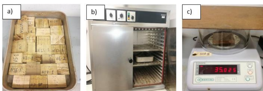
Figura 3.19- Peças obtidas para determinação do teor de água a). Colocação das peças no interior do forno b). Pesagem das peças c).
