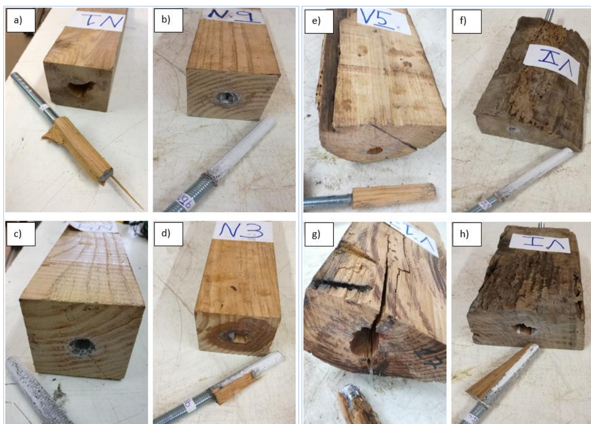
Figura 4.7- Modos de rotura observados nos ensaios de GiRs em madeira nova a)-d) (esq a .), e em madeira antiga e)-h) (dir a ).
