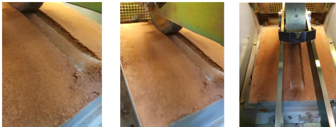
Figura 4.8 - Pormenores do estado do solo tratado após o ensaio de pista com líquido 2 Nota-se no Quadro 4.4 a melhoria percentual deste tipo de soluções já referidas. Para ensaio 9 houve uma melhoria de 19.5% na deformação, enquanto o ensaio 5 apresentou uma melhoria de 25%. Já o ensaio 7 observou-se uma melhoria bastante significativa com um aumento de 57% na melhoria de deformação. No que toca ao número de ciclos, comparativamente ao solo natural, todos melhoraram para 111 vezes mais a sua resistência à passagem de veículos ligeiros. Tendo sido este, o limite de número de ciclos imposto no ensaio de pista, os ensaios sugerem que o solo depois de estabilizar suportaria sem problemas a passagem de veículos ligeiros.
