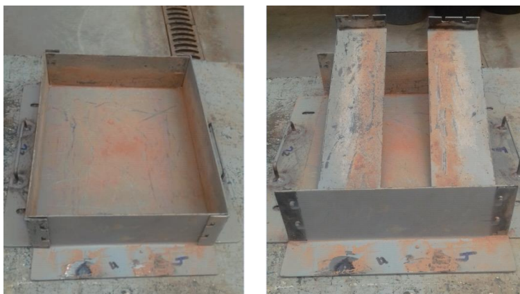
Figura 3.4 - Molde utilizado para provetes de ensaios de pista
