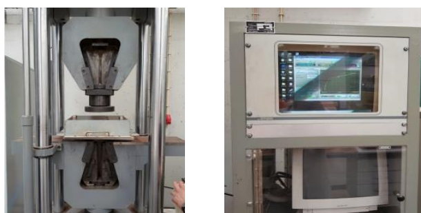
Figura 3.5 - Prensa hidráulica utilizada para a densificação
