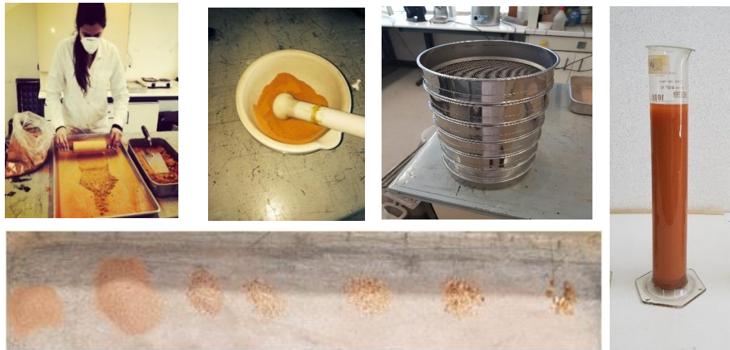
Figura 3.2 – Preparação da amostra e ensaios de Peneiração e Sedimentação para o cálculo da curva granulométrica
