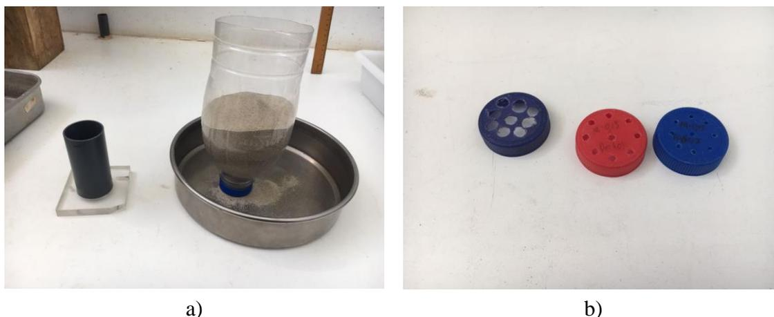
Figura 3.6 – Equipamento adotado para a aplicação do método de pluviação: a) pluviador; b) controladores de fluxo.
