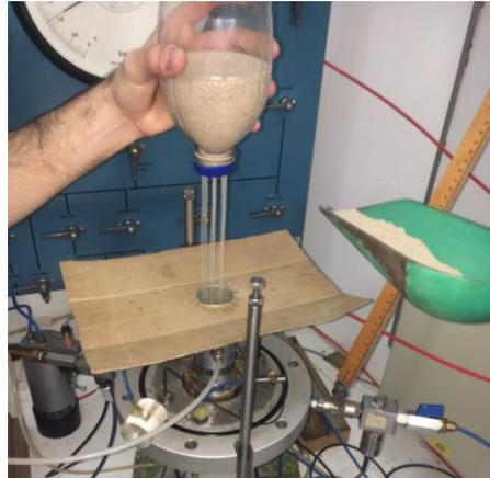
Figura 3.5 – Aplicação do método de pluviação.
