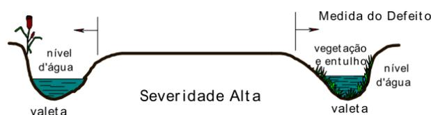
Figura 2.13 – Drenagem inadequada com severidade alta (ODA, 1995)
