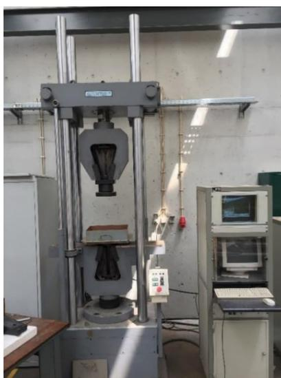
Figura 3.8 – Prensa hidráulica utilizada para a densificação das camadas do solo
