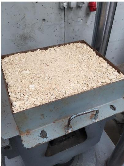
Figura 3.4 – Pormenor da camada granular após a compactação
