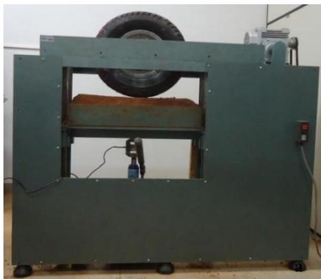
Figura 2.28 – Simulador linear de tráfego utilizado nos ensaios de Oliveira et al. (2016)
