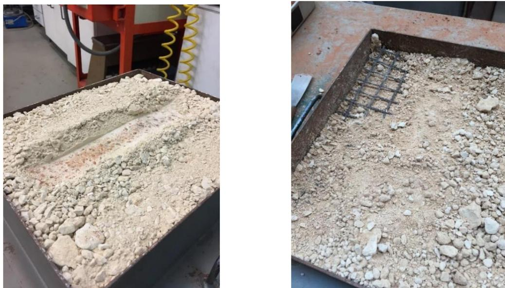
Figura 4.15 – Pormenor da deformação do solo/tout-venant reforçado com geogrelha preta (mais flexível)
