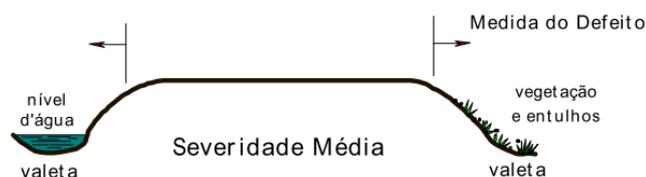
Figura 2.12 – Drenagem inadequada com severidade média (ODA, 1995)
