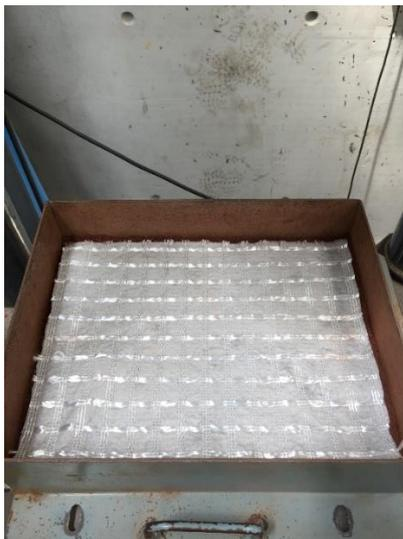
Figura 3.6 – Geotêxtil utilizado nos ensaios de pista
