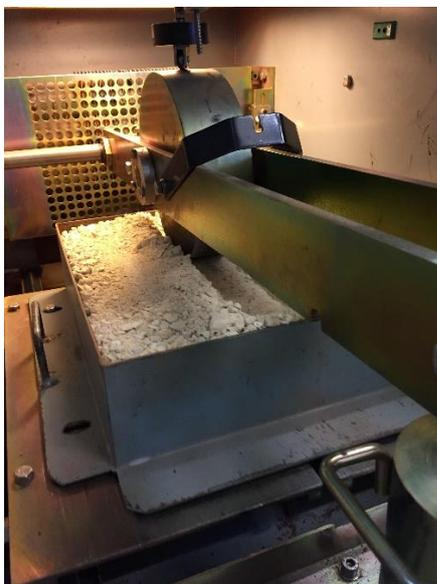
Figura 4.10 – Pormenor do provete solo/tout-venant sem reforço preparado com carga de 30kN
