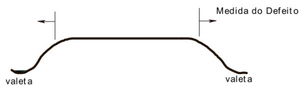
Figura 2.11 – Drenagem inadequada com severidade baixa (ODA, 1995)
