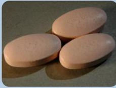
Marcas cinzentas na superfície dos comprimidos resultante da interação entre o dióxido de titânio do revestimento e as paredes de aço inoxidável do tambor
