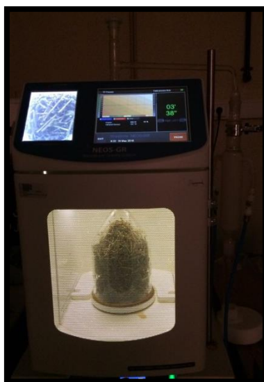
Figura 9 - Obtenção dos hidrodestilados por hidrodestilação assistida por micro-ondas
