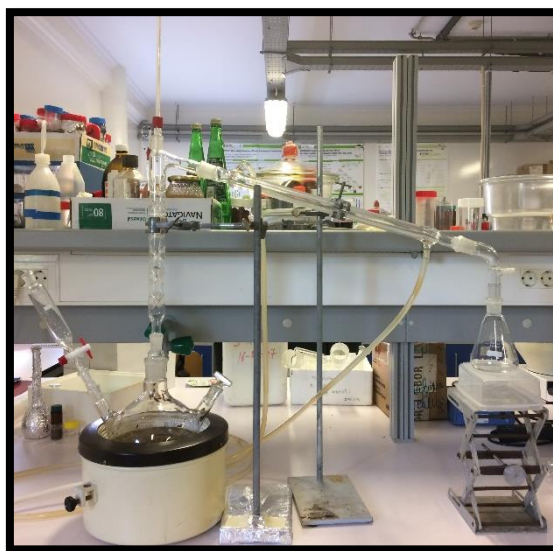
Figura 8 – Obtenção dos hidrodestilados por hidrodestilação convencional
