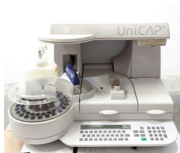
ANEXO 5: Equipamento imunoenzimático de fluorescência e respetivos parâmetros analíticos avaliados.
