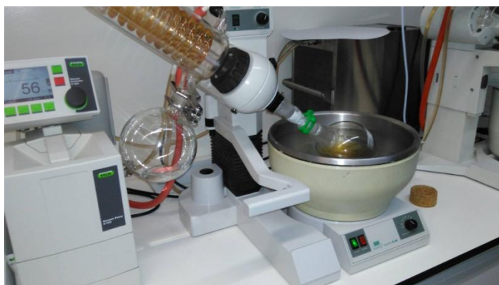
Figura 11: Evaporador rotativo, a pressão reduzida: concentração da AHD obtida após hidrodestilação da planta
