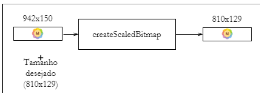
Figura 35- Exemplificação do comportamento da função createScaledBitmap .
