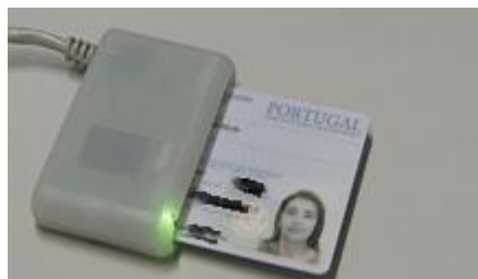
Figura 17- Exemplo de leitor de smartcards com cartão de cidadão inserido retirado de: http://www.cm-vianadoalentejo.pt/pt/intra/PublishingImages/CC1.png?RenditionID=16&Width=639&Height=362 .
