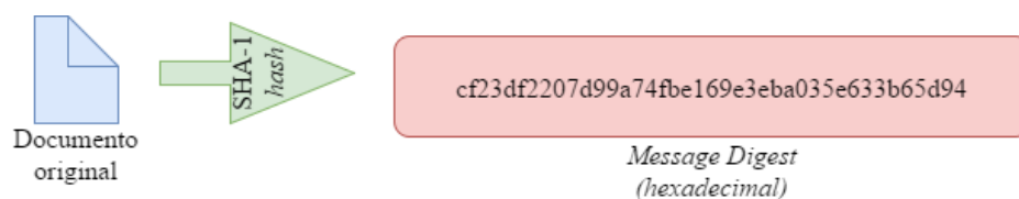
Figura 2- Aplicação de um algoritmo de hash SHA-1 sobre um ficheiro.
