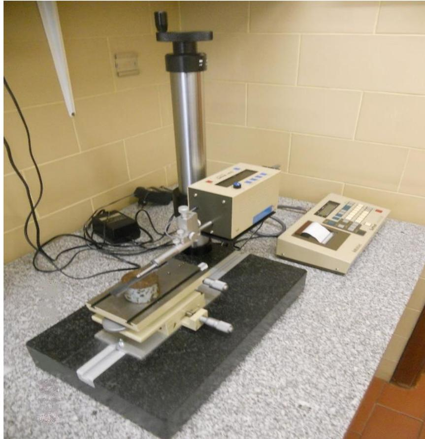
**Figura 6.2.** Perfilômetro de Contato, *Mitutoyo Surftest, model 402* (F. Autor).
