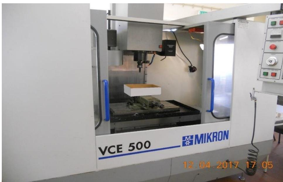
**Figura 4.2.** Fresadora (CNC), MIKRON, *model* VCE500. Preparação para maquinagem (F. Autor).
