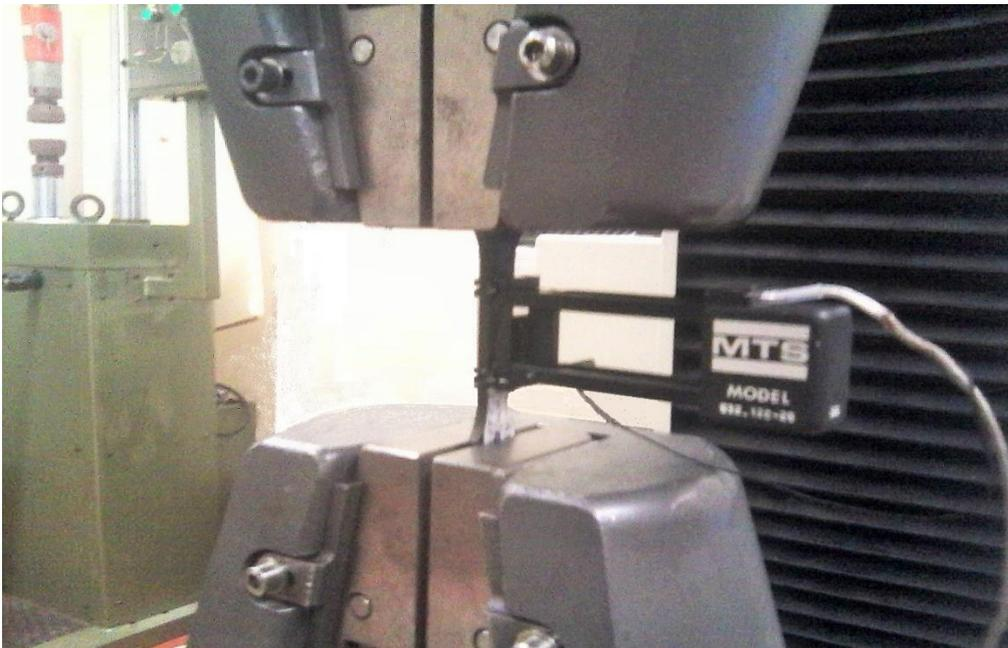
**Figura 6.4.** Máquina Instron, modelo 4206, ensaio de tração (F. Autor).
