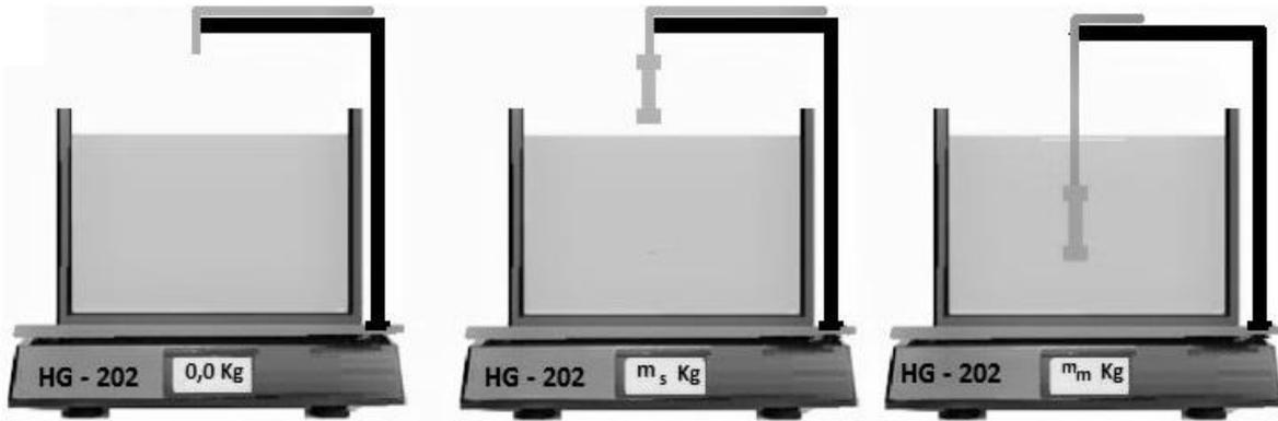
**Figura 6.1.** Medida da ( $m_s$ ), massa seca e ( $m_m$ ) massa do provete emerso em água.
