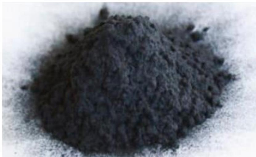
**Figura 2.11.** Fibras Picadas "*Milled Carbon Fiber*" (F. Autor: Fonte, Arquivo pessoal do autor).
