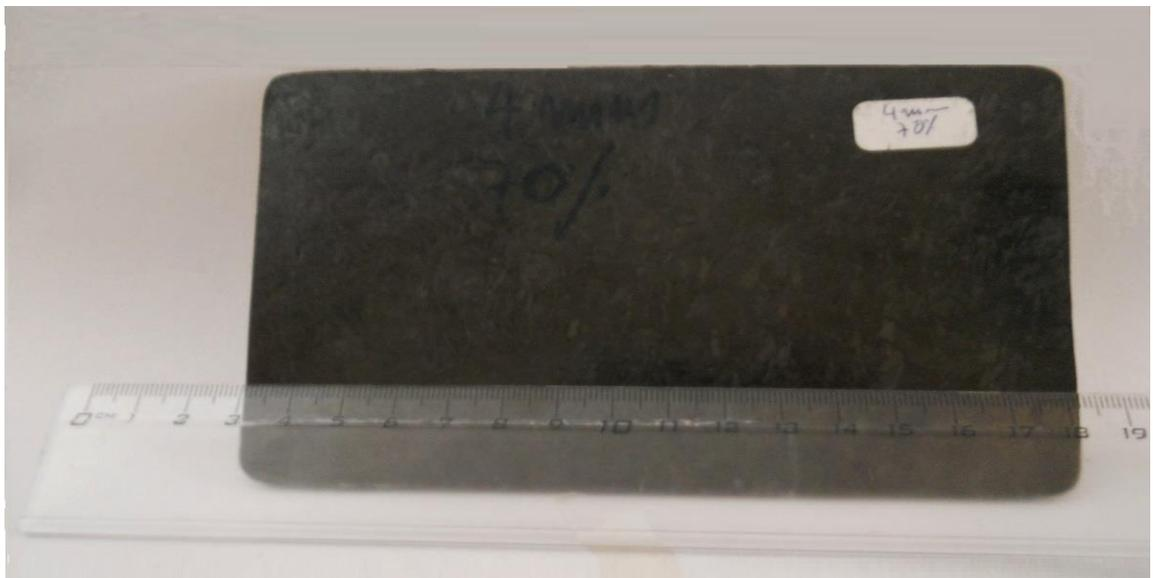
**Figura 5.4.** Placa de compósito, largura 100mm, comprimento 150mm e espessura 5mm, antes do processo de maquinagem (F. Autor).
