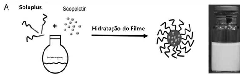
Figura 4 - Esquema da preparação da escopolatina encapsulada em micelas Soluplus®. Adaptado de [36].
