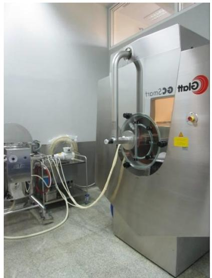
**Figura 6** Sala de Revestimento (GLATT GC SMART 350)
