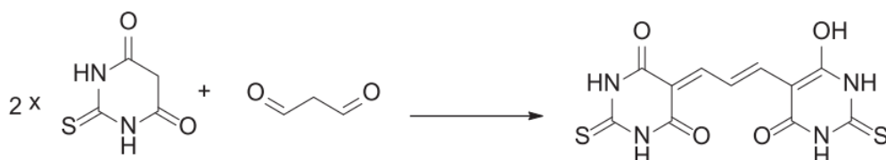
Figura 12 - Reação de dois ácidos 2-tiobarbitúrico com malondialdeído e formação de aduto.
