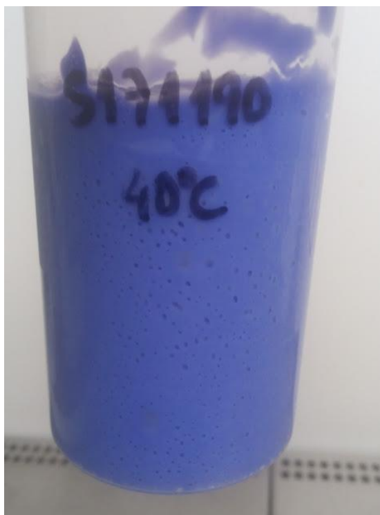
Figura 1 – Liberação de O_2 por uma amostra colocada a 40^\circ C .
