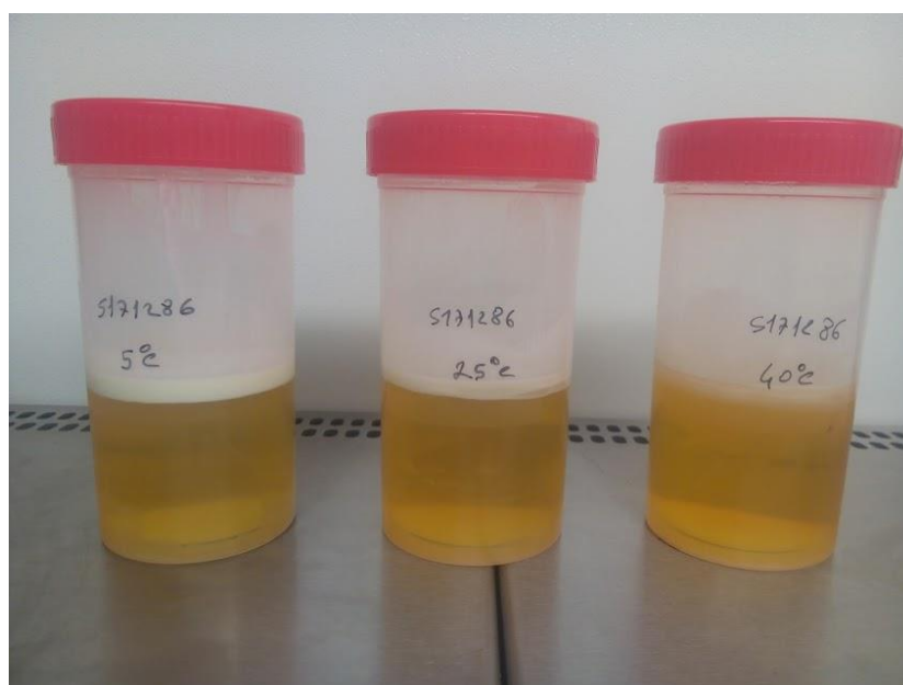
Figura 2 – Separação de fases do mesmo produto a diferentes temperaturas.
