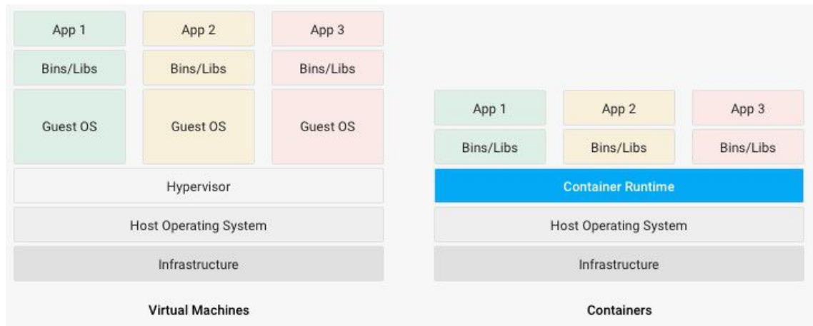
Figura 2.3: Virtual Machines vs Contentores [7]
