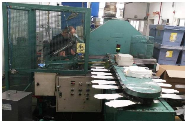
Figura 6 - Revestimento através da tecnologia *Dotting* na seção de PVC
