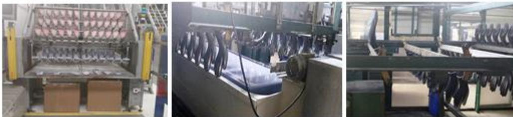
**Figura 8 - Revestimento das luvas na seção *Hyflex***
