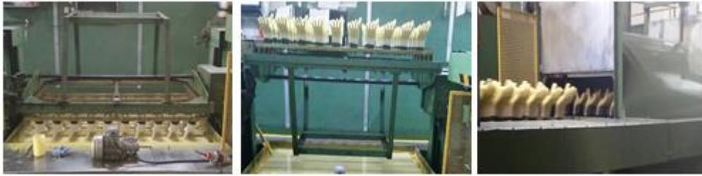
**Figura 7 - Revestimento e vulcanização das luvas na seção *Hycron***
