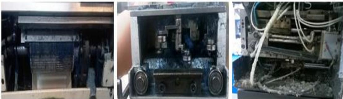
Figura 11 - Exemplo de sujidade nos teares da Tricotagem
