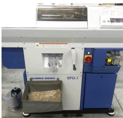
**Figura 10 - Saída do *liner* no tear**
