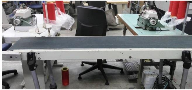
Figura 5 - Células de fluxo contínuo na seção de Costura
