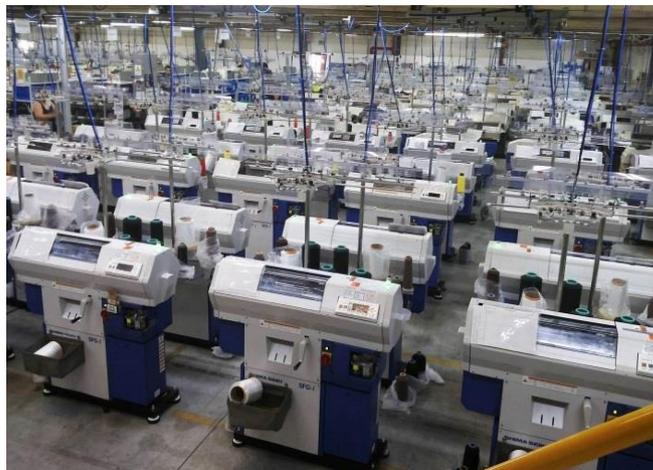
**Figura 4 - Chão de fábrica da seção de Tricotagem**
