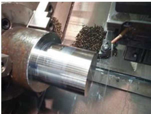
Figura 2.19. Montagem para os ensaios de corte
