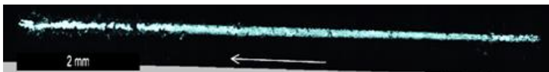
Figura 3.14. Micrografia de uma indentação completa de uma amostra que não foi jateada antes de ser revestida (10x)
