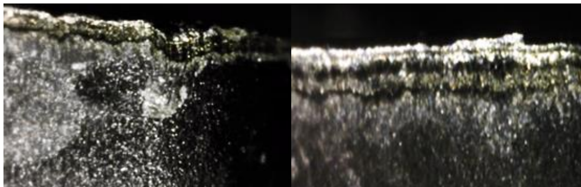
Figuras 3.18 Aspeto de uma pastilha não jateada a) e jateada b) ao fim de 3 min de ensaio
