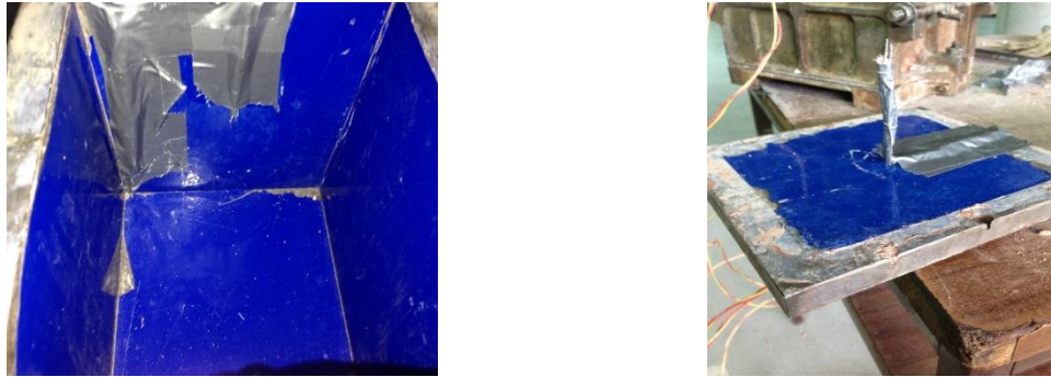
Figura 3.6 - Instrumentação do provete e molde de controlo.
