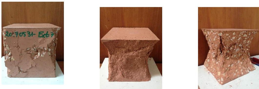
Figura 3.10 - Superfícies de rotura de provetes realizados durante o processo experimental.
