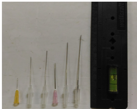
Figura 3.4: Agulhas utilizadas durante os ensaios, ordenadas do diâmetro menor para o maior.
