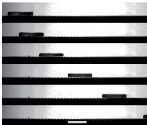
Figura 1.5: Propulsão de gelo seco. Um disco de dióxido de carbono sólido numa calha dentada aquecida propulSIONA-se, como observado em gotas líquidas. A barra indica 1 cm e o intervalo de tempo entre cada foto é de 300 ms . [Extraída de Lagubeau et al. (2011)]
