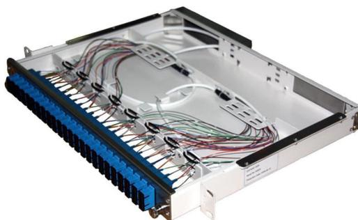
Figura 22 - Repartidor ótico.
