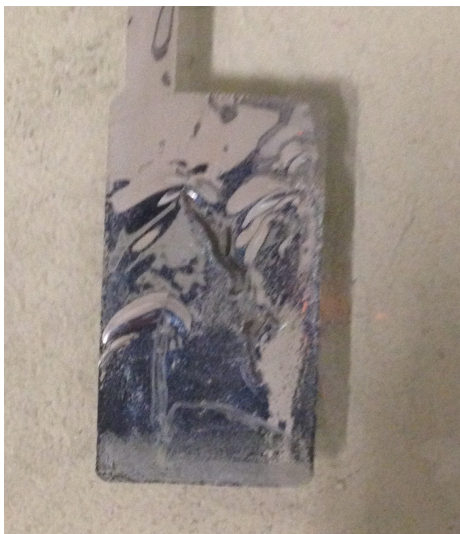
(d) No use of ease release: wrinkles
