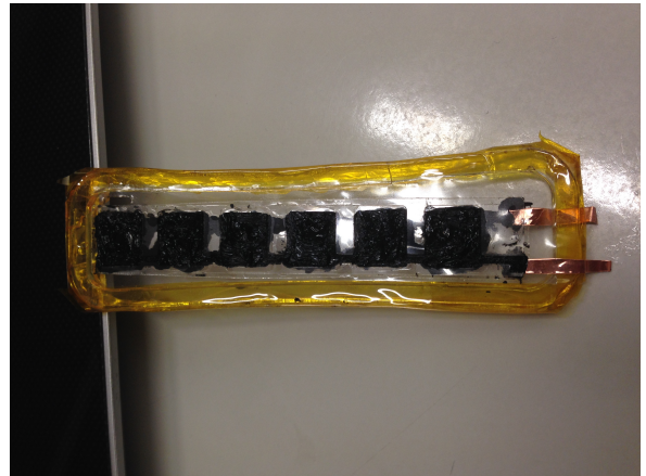
(d) Both inner plastic frames cut
