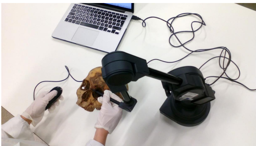
Figura 3.1 – Recolha de dados de um cranium da CEI/XXI onde é possível visualizar o comando de controlo remoto e o digitalizador MicroScribe® G2X.
