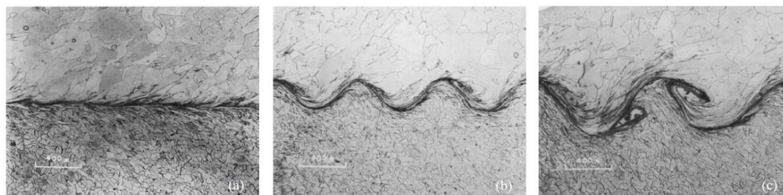
Figura 2.3. Diferentes tipos de interface: a) interface plana; b) interface ondulada ; c) interface com camada de material fundido (Cowan et al. 1971).
