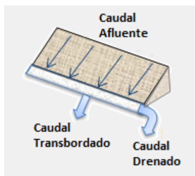
Figura 3.5 - Representação de uma desconexão do telhado no SWMM (Adaptado do SWMM)
