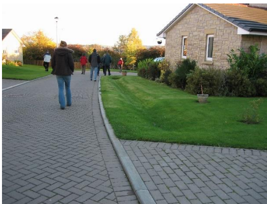
Figura 3.14 - Pavimento Permeável (SUDSnet@, 2017)
