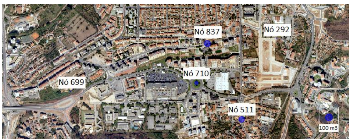
Figura 4.5 - Representação visual dos volumes de inundação das câmaras de visita para o cenário 4 (Desconexões de Telhado e Pavimentos Permeáveis)
