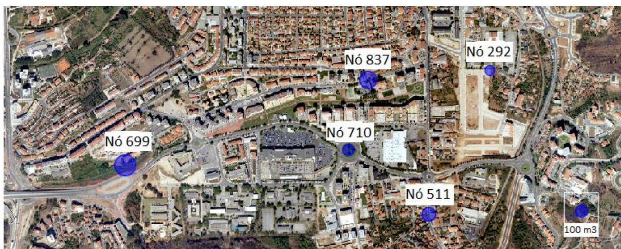
Figura 4.2 - Representação visual dos volumes de inundação das câmaras de visita para o cenário 1 (Desconexões de Telhado)
