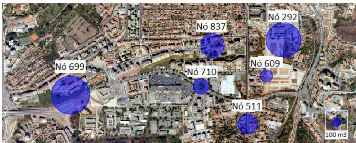
Figura 4.1 - Representação visual dos volumes de inundação das câmaras de visita para o cenário 0 (inicial)
