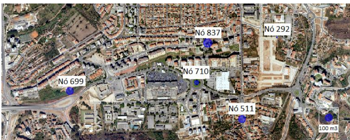
Figura 4.3 - Representação visual dos volumes de inundação das câmaras de visita para o cenário 2 (Depósitos de Armazenamento de Águas Pluviais)
