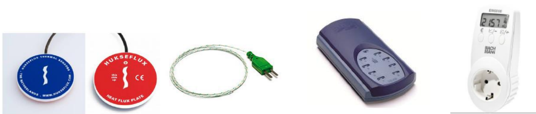
Figura 4.1 – Representação dos equipamentos usados: Termofluxímetro de modelo HFP01 da marca Hukseflux; Termopar do tipo K; Datalogger; Medidor de energia
