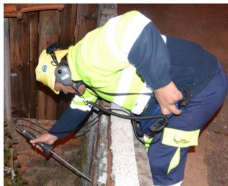
**Figura 3.4.** Detecção precisa: a) na conduta b) no contador - Fonte: autor
