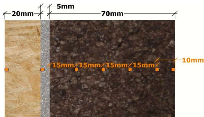
Figura 2.1 – Corte da parede com representação dos pontos de medição representados a cor de laranja.
