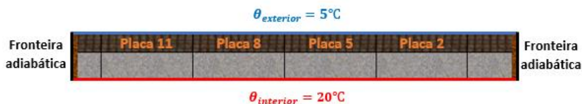
Figura 2.7 – Condições de fronteira da solução 2.
