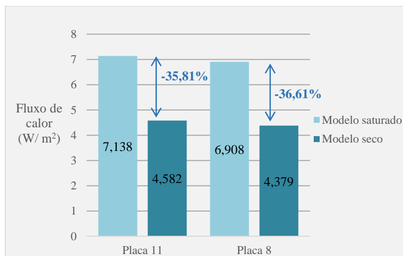
Gráfico 4.15 – Fluxos de calor ao longo do modelo com substrato do tipo roof IV seco e saturado.
