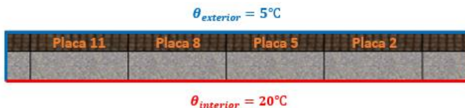
Figura 2.5 – Condições de fronteira da solução inicial.
