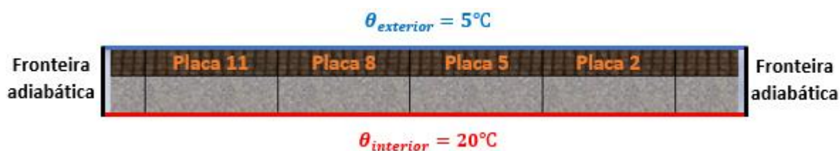
Figura 2.6 – Condições de fronteira da solução 1.
