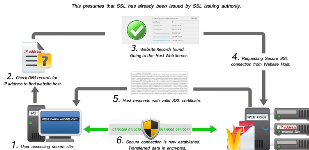
Figura 30 - Funcionamento HTTPS Fonte: Nitsan Technologies, 2017
