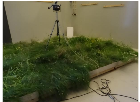
Figura 3.18 – Ensaio em câmara reverberante do substrato S1 com os tapetes vegetais, em julho, V1 (à esquerda) e V2 (à direita)
