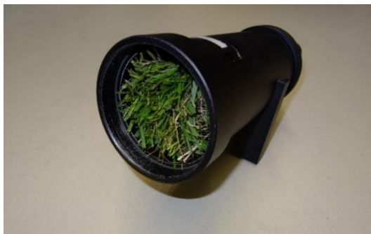
Figura 3.5 – Fotografia da amostra S1 + V1 ensaiada em tubo de impedância
