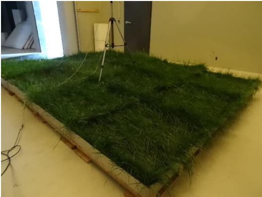
Figura 3.18 – Ensaio em câmara reverberante do substrato S1 com os tapetes vegetais, em julho, V1 (à esquerda) e V2 (à direita)
