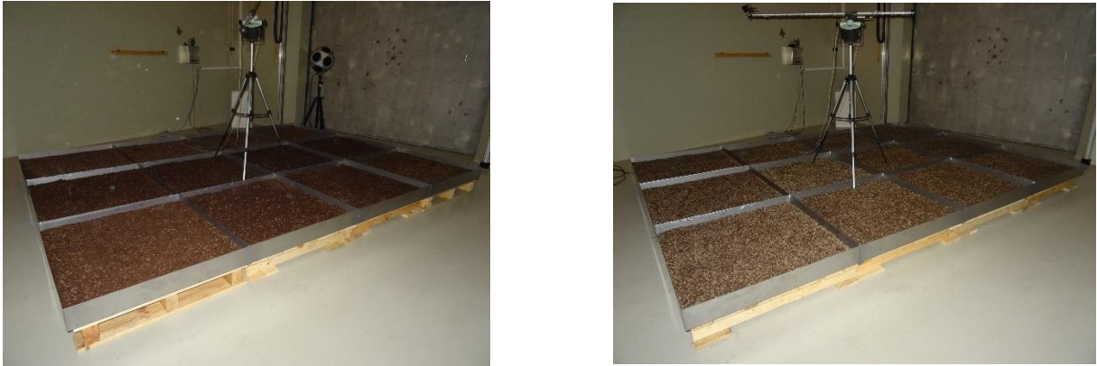
Figura 3.16 – Ensaio em câmara reverberante dos substratos S1 (à esquerda) e S2 (à direita)
