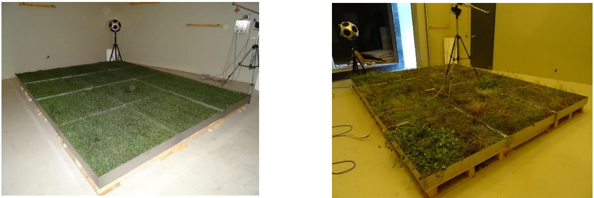
Figura 3.17 – Ensaio em câmara reverberante do substrato S1 com os tapetes vegetais, em maio, V1 (à esquerda) e V2 (à direita)
