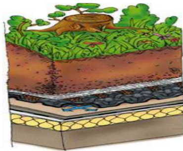
Figura 2.10 – Representação detalhada por camadas de uma cobertura verde intensiva (Pittaluga, I. et al., 2011)
