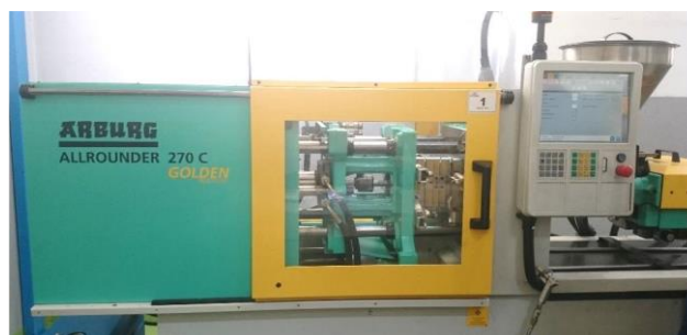
Figura 2.9 - Equipamento usado para injeção dos provetes (Mariteste - Injeção e Produção de Plásticos Técnicos Lda)
