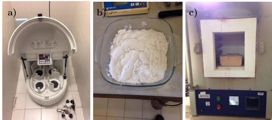
Figura 2.2 - Sequência da preparação das lamas: a) Equipamento de lavagem (moinho sem bolas); b) Lama resultante do processo de lavagem; c) Forno de secagem
