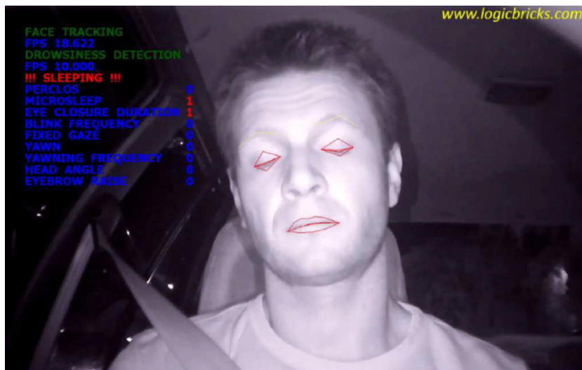
FIGURA 3.12: Sistema demo da Xylon usado para a deteção da sonolência. (Retirado de [53])
