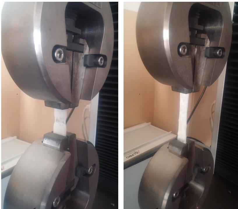
Figura 3.27: Ensaio de tração dos provetes impressos transversalmente.
