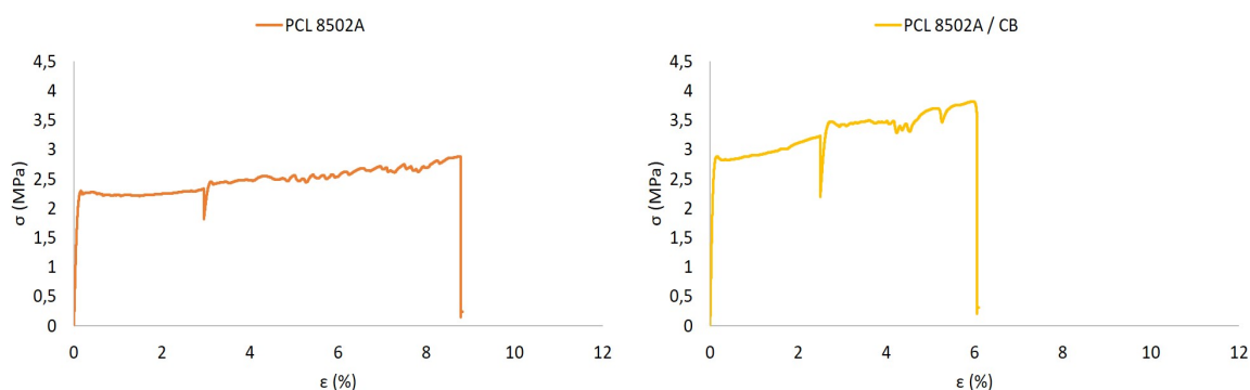
Figura 3.36: Curvas tensão-deformação dos provetes porosos PCL 8502A, sem e com a CB.
