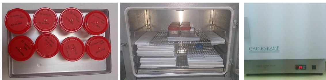
Figura 3.4 – Sequência do processo de imersão das amostras em saliva artificial.
