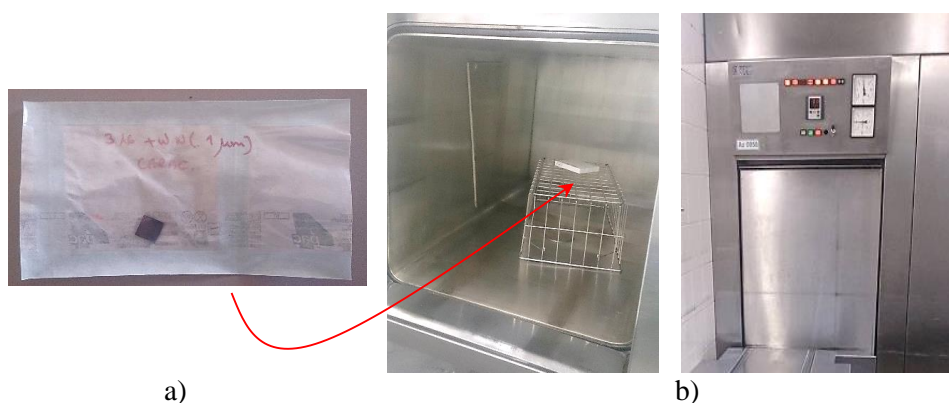
Figura 3.3 – a) Amostra selada em manga de esterilização e b) equipamento esterilização.
