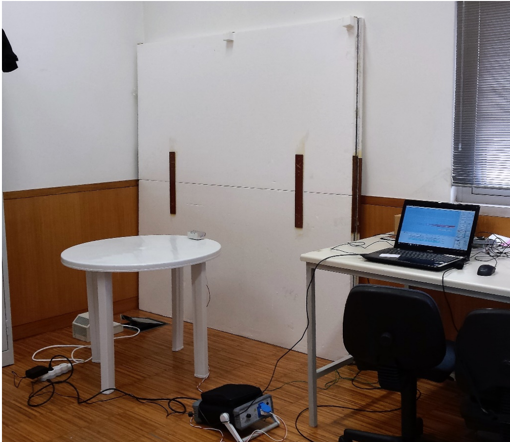
Figura 4.14: Montagem para o ensaio de emissão conduzida.
