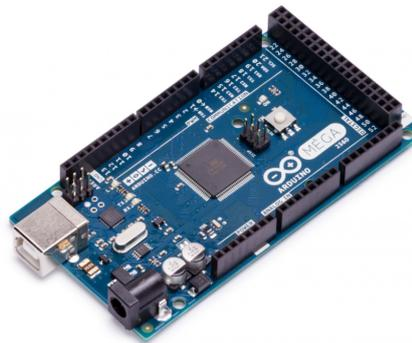
Figura 3.2: Arduino Mega 2560
