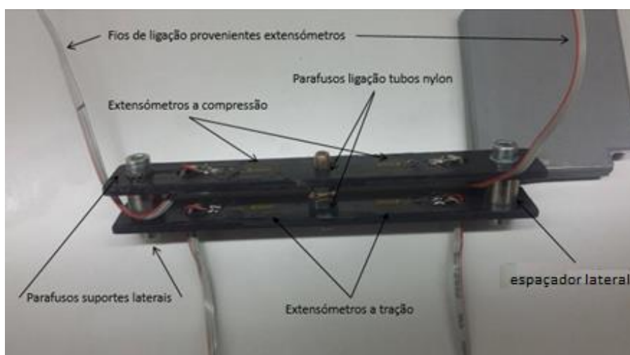
Figura 14 - Célula de Carga após reparação.
