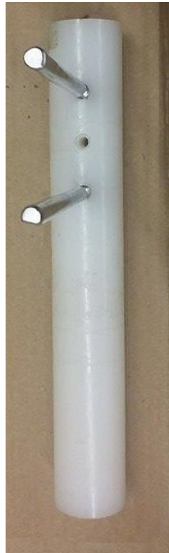
Figura 20 – Varão de nylon com furo sem pino roscado
