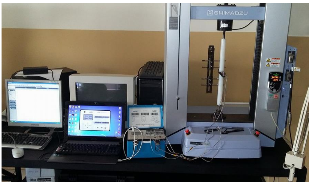
Figura 18 - Montagem Experimental para ensaios de compressão.
