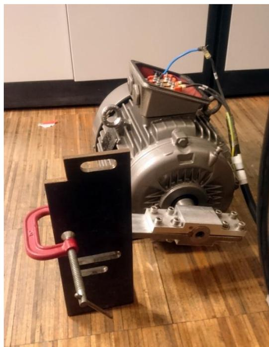
Figura 17: Motor com o rotor bloqueado.
