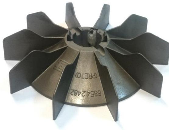
Figura 14: Ventilador do motor testado.
