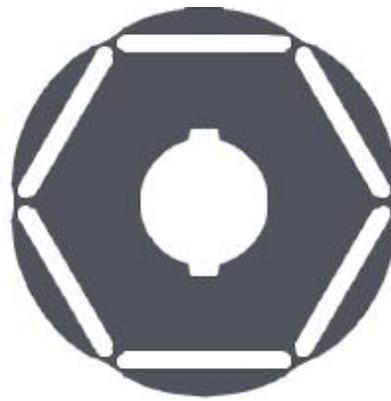
*Figura 8: Secção do rotor do motor testado.*
