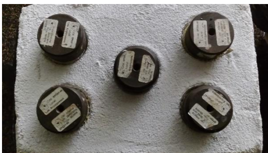
Figura 3.7 - Ensaio de arrancamento: Áreas de ensaio com pastilhas metálicas
