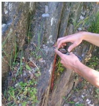
Figura 3.7: Levantamento das discontinuidades.
