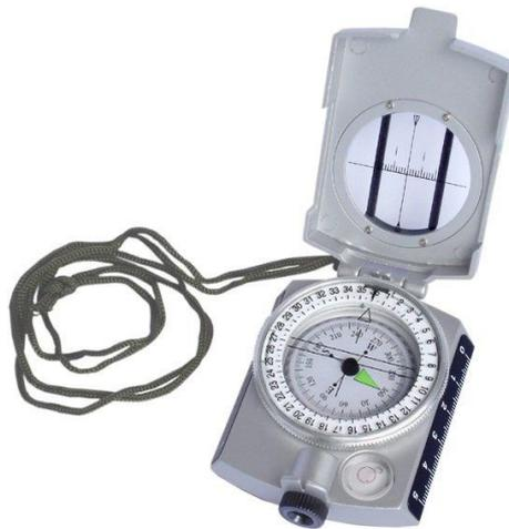
Figura 2.6: Bússola provida de clinómetro, (Maserafi, 2017).
