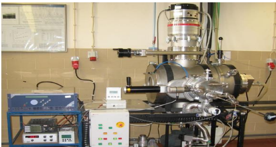
Figura 2.12– Aparelho de pulverização catódica do CEMUC.
