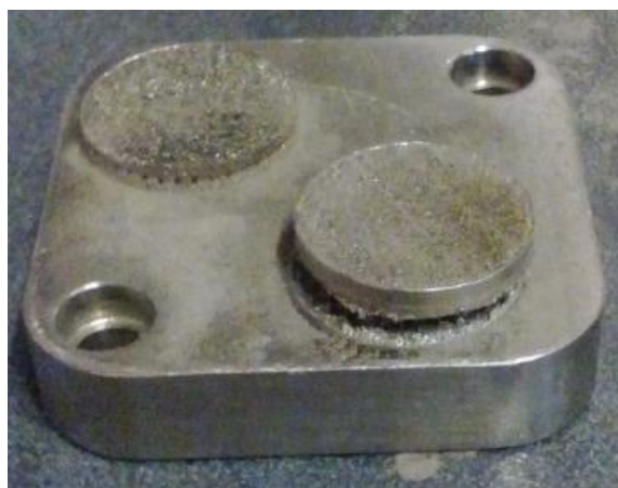
Figura 15 – Pastilha de aço ferramenta H13 com grafite revestida.
