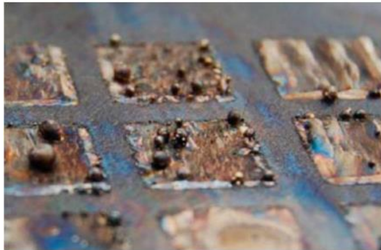
Figura 1.10. – Efeito “balling” em SLM [59].
