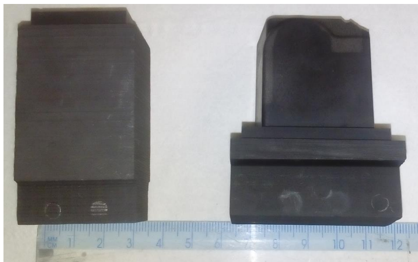
Figura 2.1 – Électrodos usados para a obtenção de pó de grafite.
