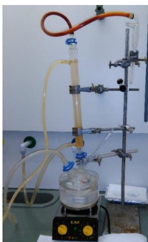
Figura 16 - Montagem utilizada para garantir atmosfera inerte na síntese do material da formulação A-BCD.
