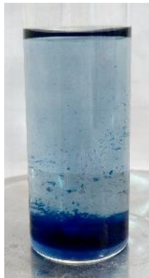
Figura 38 - Aspeto de um frasco onde ocorreu adsorção do corante azul com concentração de 80 \text{ mg L}^{-1} usando o adsorvente A-TM.
