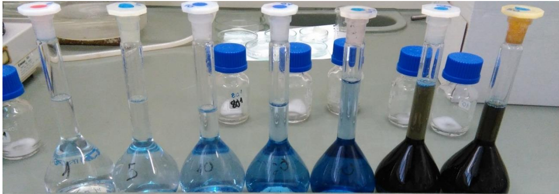
Figura 36 - Conjunto de soluções diluídas do corante azul com concentrações de 1, 5, 10, 20, 40, 60 e 80 \text{ mg L}^{-1} .
