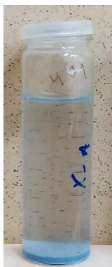
Figura 41 - Aspeto de um frasco onde ocorreu adsorção do corante azul com concentração de 40 \text{ mg L}^{-1} usando o adsorvente X-TA.
