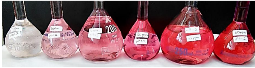
Figura 19 - Soluções do corante rubi com pH=2 e concentrações de 1 mg L -1 , 5 mg L -1 , 10 mg L -1 , 20 mg L -1 , 40 mg L -1 e 80 mg L -1 , respetivamente.
