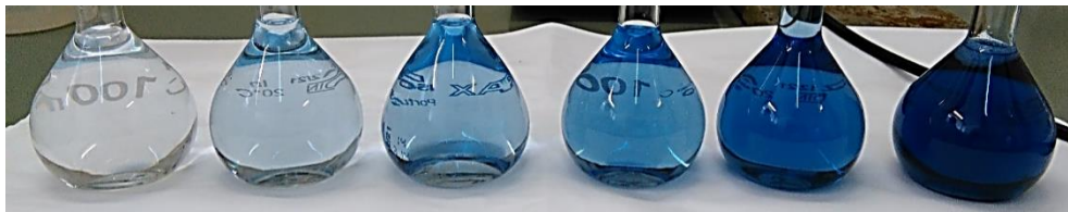
Figura 20 - Soluções do corante azul com concentrações de 1 mg L -1 , 5 mg L -1 , 10 mg L -1 , 20 mg L -1 , 40 mg L -1 e 80 mg L -1 , respetivamente.
