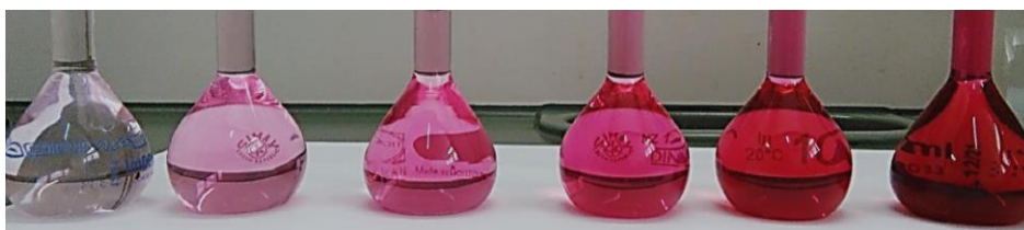
Figura 18 - Soluções do corante rubi com concentrações de 1\text{ mg L}^{-1} , 5\text{ mg L}^{-1} , 10\text{ mg L}^{-1} , 20\text{ mg L}^{-1} , 40\text{ mg L}^{-1} e 80\text{ mg L}^{-1} , respetivamente.
