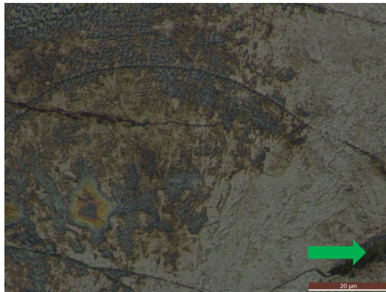
Figura 33 – Imagem microscópica da microestrutura ao longo da fenda (20μm).
