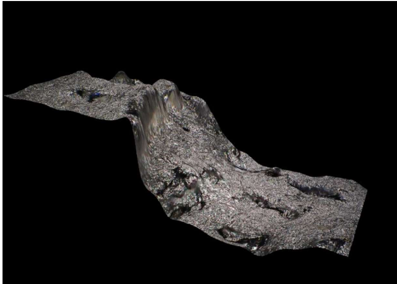
Figura 36 – Imagem microscópica 3D da superfície de fratura ao longo da fenda.
