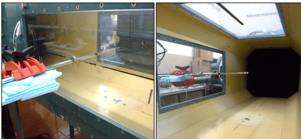
Figura 3.2. Instalação do anemómetro de fio quente na secção de ensaios.
