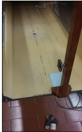
Figura 3.9. Disposição das massas para a calibração da componente horizontal da balança.
